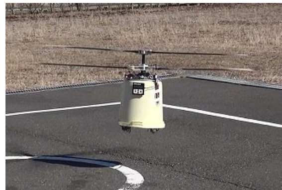
同軸二重反転式ヘリコプタ小型モデル
